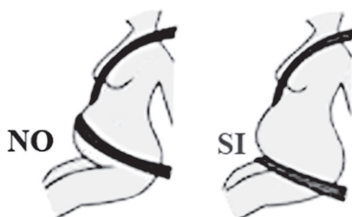
Figura 6: Cinturón de seguridad y su buen uso durante el embarazo
